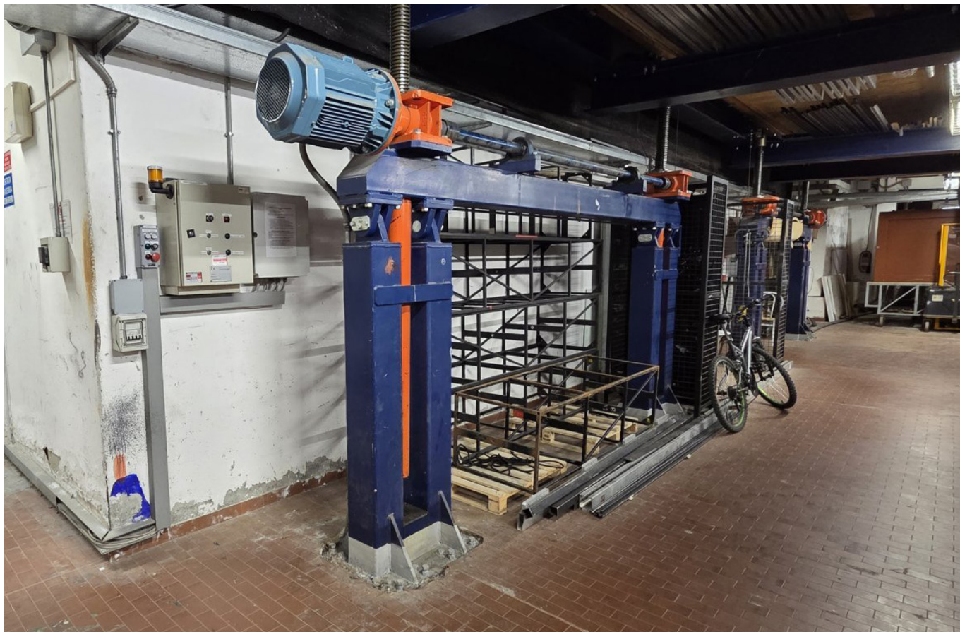
1: Vista del sistema di funzionamento del palco mobile
